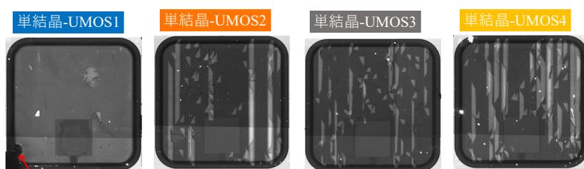
4<sup>th</sup> 1500 A/cm<sup>2</sup> 試験中 破損
